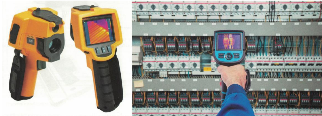
Kamera termowizyjna i pomiar z użyciem kamery termowizyjnej
